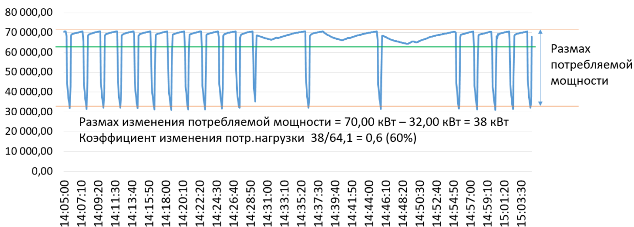
Рис. 5 Пример обработки результатов измерения двигателя компрессора 90 кВт
